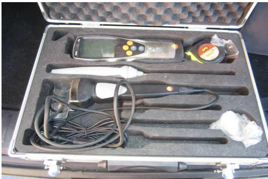
Rys. 72. Urządzenie pomiarowe Testo 635-2 [testo.com].
